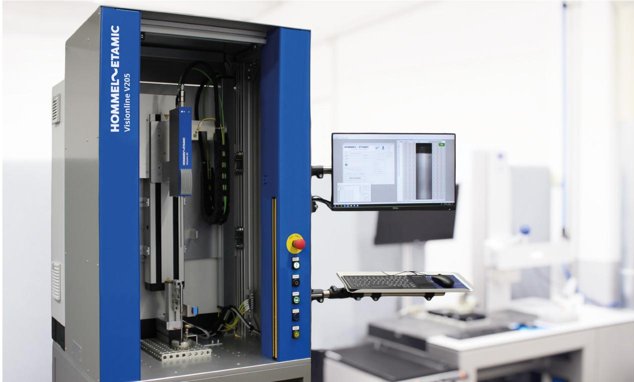
Konfigurationsbeispiel optisches Inspektionssystem Visionline V205
