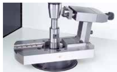
Werkstückspezifischer Radialmitnehmer für Nockenwellen zur Winkelindexierung in einer Nut
