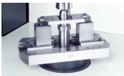
Werkstückspezifischer Axialmitnehmer für Kurbel- und Nockenwellen zur Winkelindexierung in Axialbohrungen
