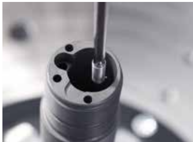
Formmessung in kleinen, tiefen Bohrungen
