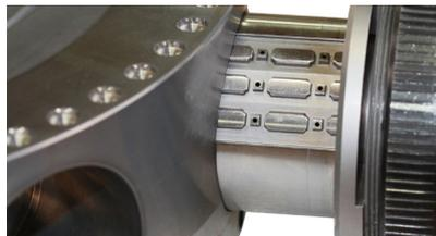
Tampon spécial à 12 buses pour mesure d'alésage de distributeur hydraulique
