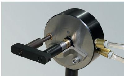
Bague de mesure spéciale à deux plans de mesure avec assistance au chargement
