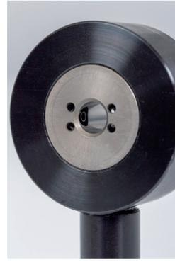
Bague de mesure standard à deux trous n° 2
