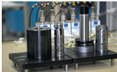
Mesure d'appairage avec bague et tampon spéciaux multi-niveaux
