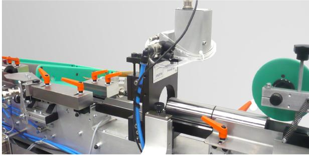
Exemple d'intégration d'une bague AG280 avec TPE99 sur un convoyeur à bande en sortie de rectifieuse centerless
