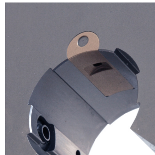
Détail du presseur pneumatique pour les diamètres inférieurs à 20 mm
