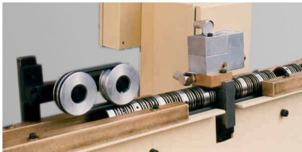
Exemple d'intégration d'une bague AG282 avec bloc de raccordement et TPE99 dans un convoyeur en sortie de centerless
