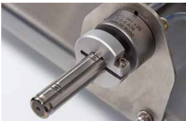
Pneumatischer Messdorn mit zwei Schlitzdüsen
