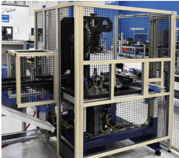
Automatische Messstation für Getriebewellen
