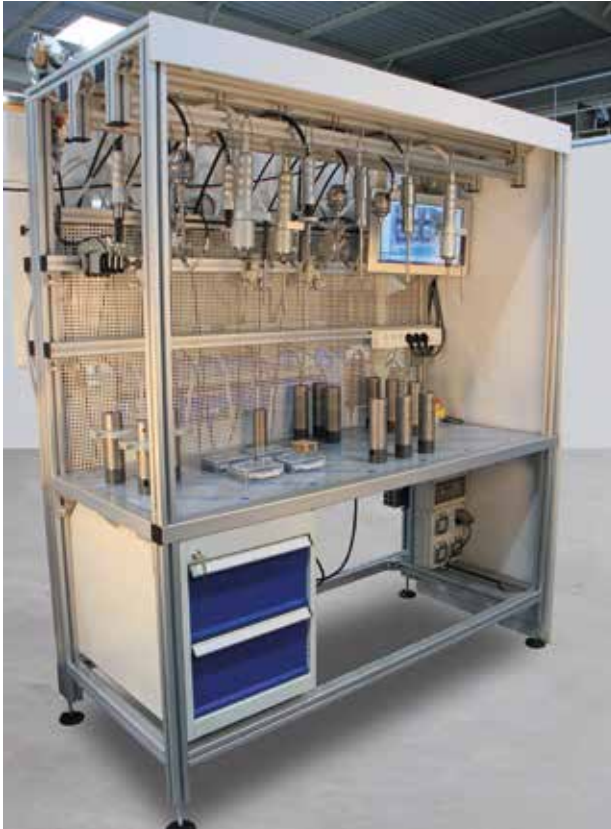
Manueller Messplatz für Zylinderköpfe
