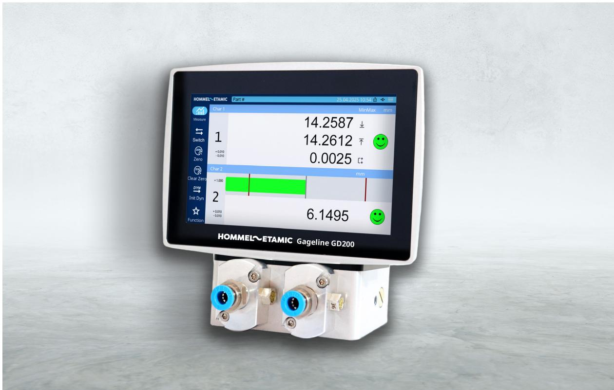
In Verbindung mit pneumatischen und/oder taktilen Messmitteln führt das Gageline GD200-Anzeigegerät Dimensionsmessungen mit extrem hoher Präzision durch. Mit zehn Messprogrammen und mehrstufigen Programmpasswörtern ist das Anzeigegerät auch durch ungeschulte Anwender einfach zu bedienen, da keine Einstellungen erforderlich sind.
