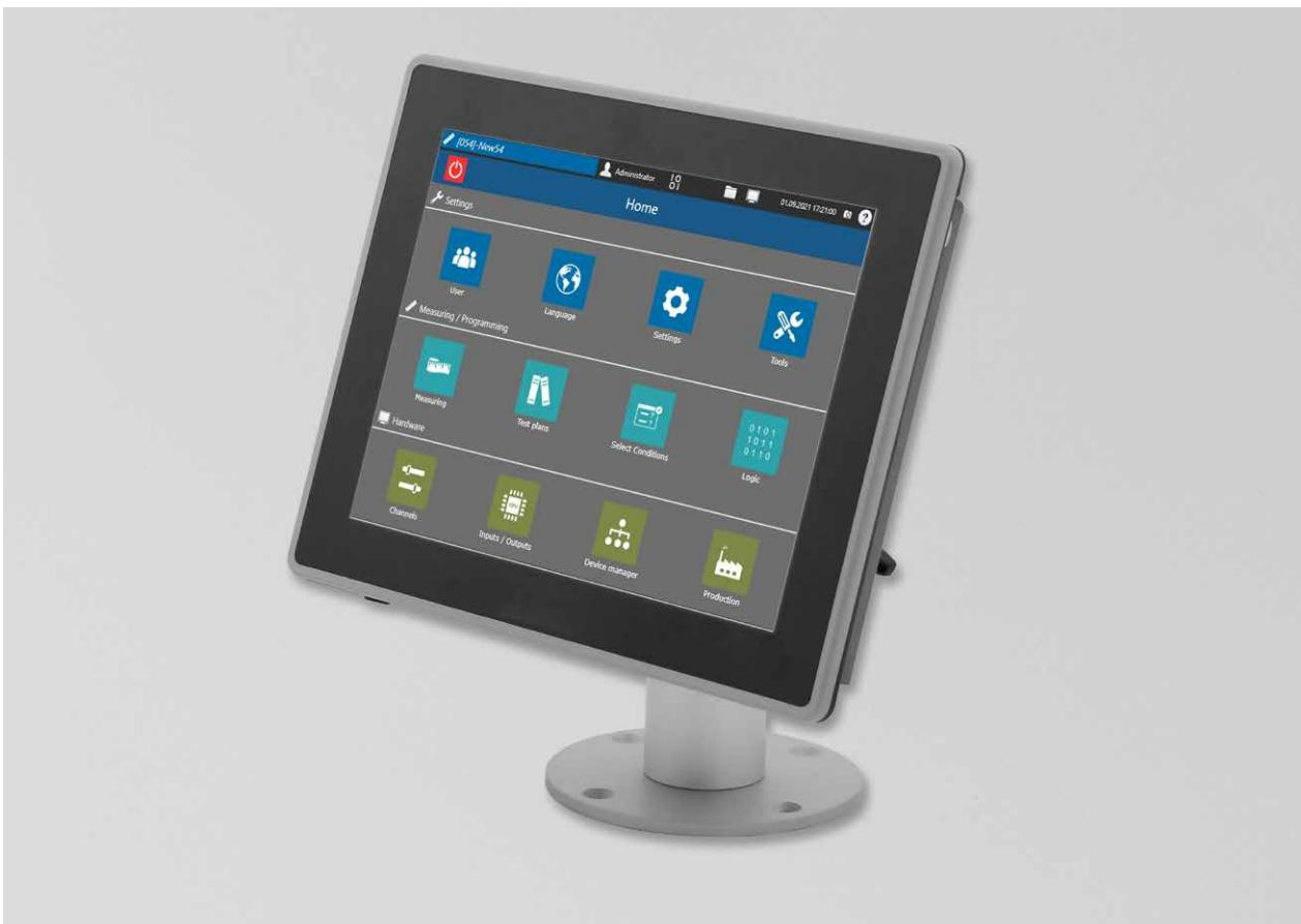
Der Gageline GD600 Industrie-Computer bietet eine flexible Lösung für alle Offline-, SPC-, Pre- und Post-Prozess-Anwendungen der dimensionellen Messtechnik im Labor und in der Produktionsumgebung.
