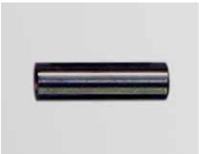
Support touche avec taraudage M2.5 Référence X426000-002 (L=20 mm) Référence X426000-003 (L=30 mm) Référence X426000-004 (L=40 mm)
