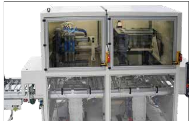
检测发动机缸体上的气缸孔和端面
