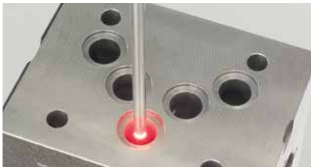
检查行走液压系统的孔内表面
