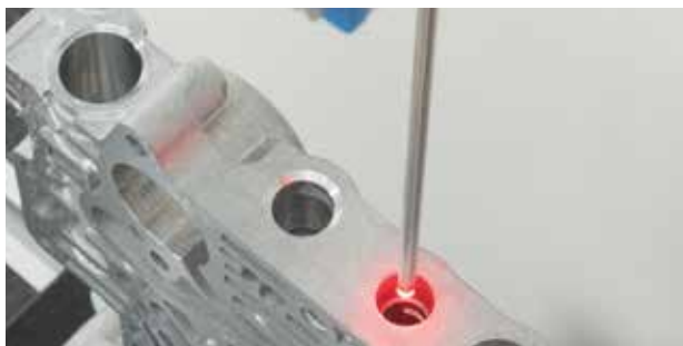
Inspection optique de surface dans les alésages
