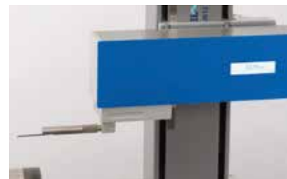
Rauheitstastsystem mit Quick-Change-Adapter
