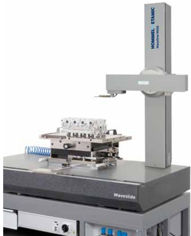
Messplatz Waveslide mit 800 mm-Säule, TKU400-Tastsystem für die Rauheitsmessung und manuell verfahrbarem Messtisch auf Luftschlitten
