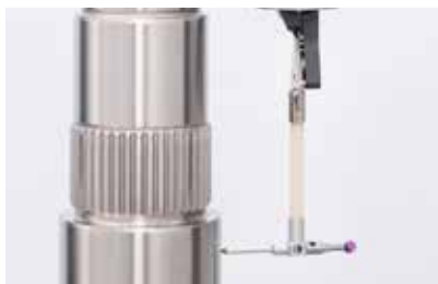
Rauheits- und Formmessung mit beidseitig wirkendem Tastsystem
