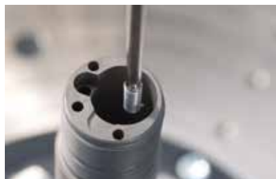
Formmessung in tiefen, engen Bohrungen
