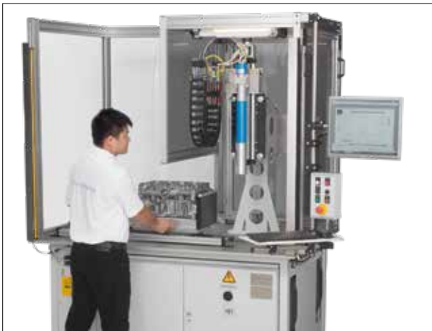
Prüfplatz mit manueller Beladung für Kleinserien-/Prototypenfertigung
