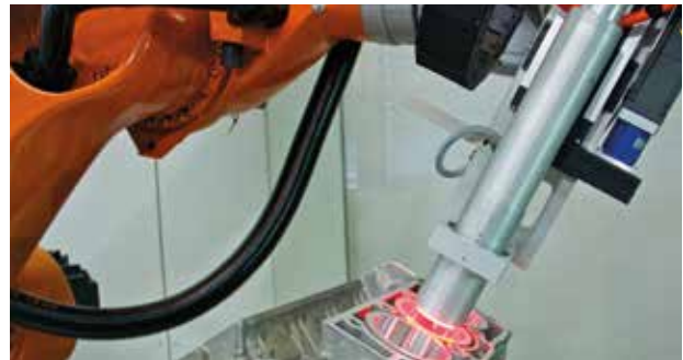
Robotergeführte Prüfwelle für Motorblöcke
