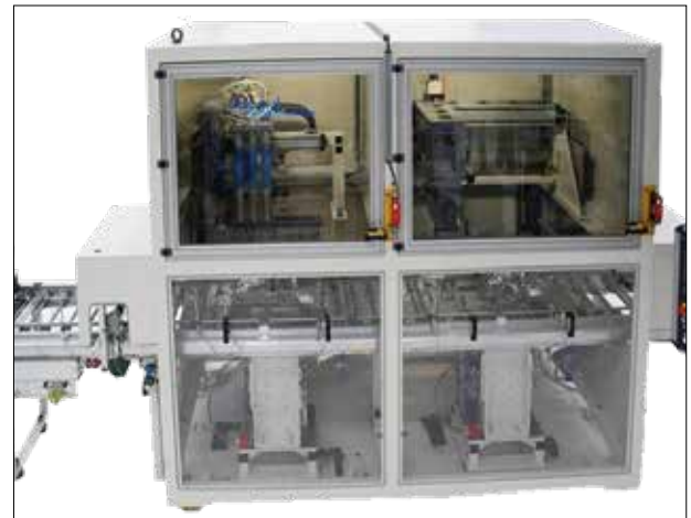
100-Prozent-Prüfung von Zylinderbohrung und Planfläche am Motorblock
